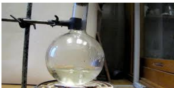
2.2.4-сүрөт. Кайноонун басымдан болгон көз карандылыгын демонстрациялоо.
