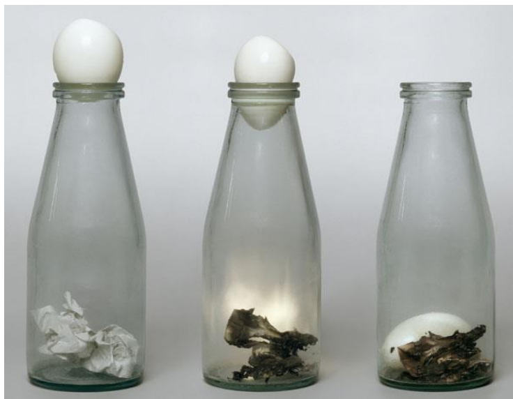
2.2.2-сүрөт. Атмосфералык басымды демонстрациялоо
